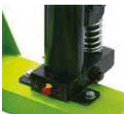
**СТОПОРНЫЙ КЛАПАН КОНТРОЛЯ НАГРУЗКИ**
