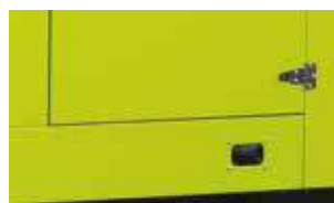
Отверстия для топливных трубопроводов
