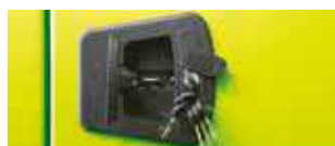
Прочная ручка капота оснащена замком
